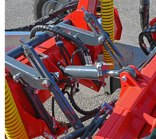
Lenker mit schmierbaren Kugelaugen. Langlebige Bauweise.
