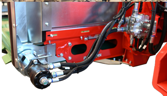
Bandantrieb erfolgt über Hydromotor OMR mit Leckölleitung – eine Kupplung für spannungsfreien Antrieb sitzt dazwischen
