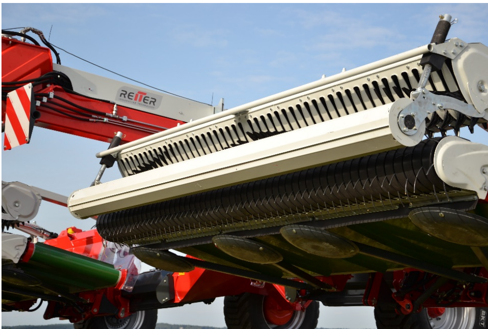
Vier Gleitteller pro Arbeitseinheit sorgen für die ideale Bodenführung der Pick-up
