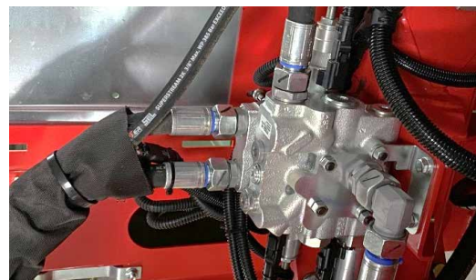
La valve du tapis détermine le sens de dépose et la vitesse du tapis - tous deux réglables via le terminal.
