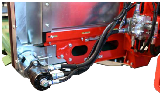
L'entraînement du tapis est assuré par un moteur hydraulique OMR avec une conduite d'huile de fuite - un accouplement pour un entraînement sans tension se trouve entre les deux.
