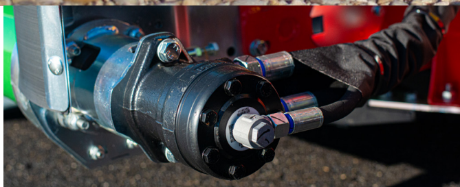
Bandantrieb erfolgt über Hydromotor mit Leckölleitung – eine Kupplung für spannungsfreien Antrieb sitzt dazwischen
